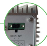
Bornier à vis pour câble d'alimentation électrique
