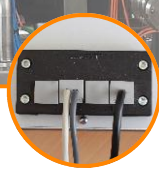
Presse étoupe fendu, gain de temps au montage (sans couper les câbles)
